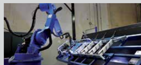
Soudure robotisée pour un cordon toujours identique.
